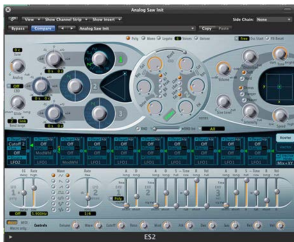
图04 LFO 设置为与工程 BPM 同步
