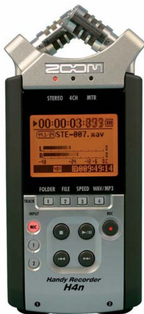
图02 24bit 立体声录音机可以让你更容易的设置录音水平，但是即使它们具备背光的显示屏，在相对漆黑的演出环境中进行参数的调整仍然不是一件容易的事情。而且现场演出的音量通常会比试音时要大，所以你一定要预留一些空间。
