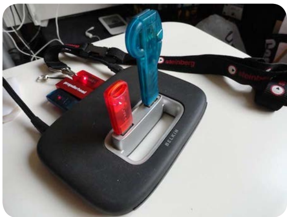
图03 要同时使用多个CMC，一个好的带额外供电的USB HUB是必须的
