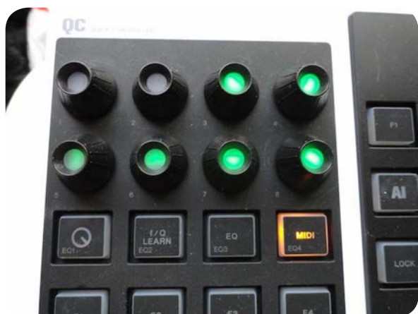
图17 无限旋转旋钮，转动到的参数高低会通过绿色LED光的强弱反应出来
