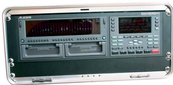
图08 专属型硬件录音机通常都比使用笔记本和音频接口更加可靠，安全。Alesis HD24可以直接或或许从调音台输出给它的信号，你也可以将通过前级放大的麦克风信号输入进来。
