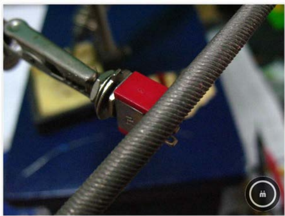
图06 防止引脚氧化
