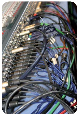
图03 很多乐器都是通过现场负责调音的调音台进行处理的，所以你可以直接从调音台中获得一路信号进行录音，这是非常可靠地方法。
